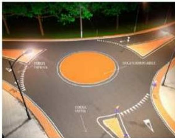
In area urbana vengono generalmente progettate rotatorie con raggio esterno massimo di 12m, con isola centrale sormontabile.
