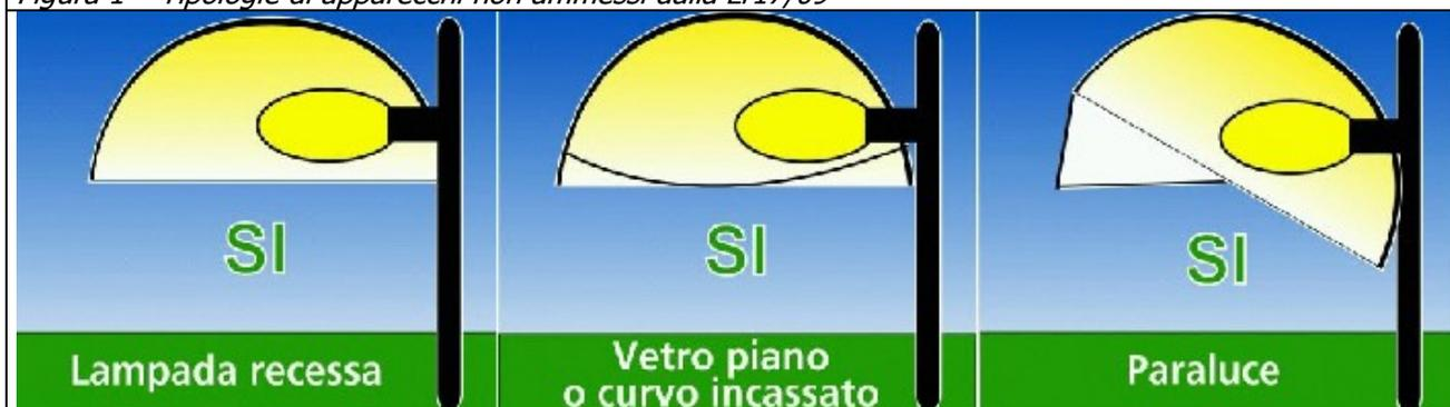
Figura 2 – Tipologie di apparecchi conformi alla legge n.17/09
