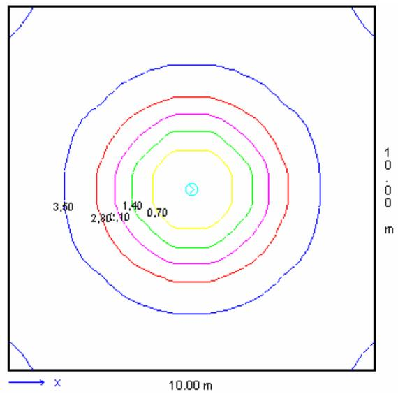
Fig. 5 - Illuminamento con curve isolux rotonde e concentriche.
