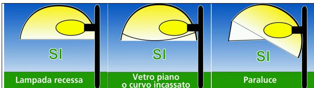
Fig.2 – Apparecchi conformi alla L.r. 17/09.
