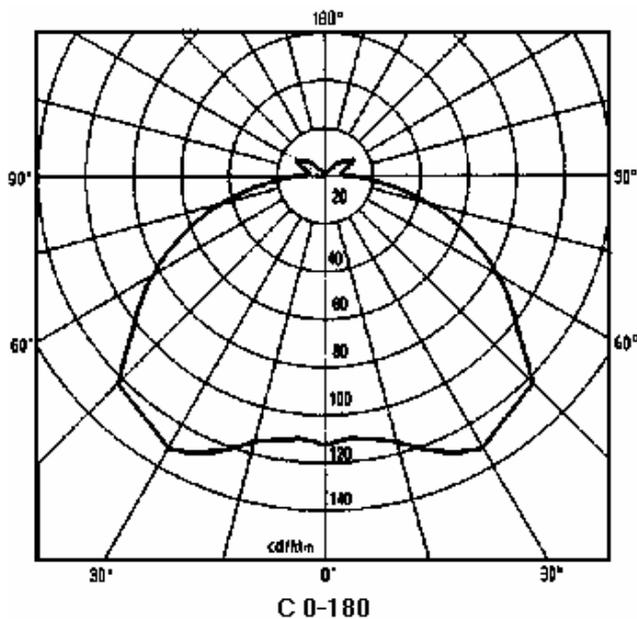
Fig. 8 - Curva non allargante di apparecchio simmetrico
