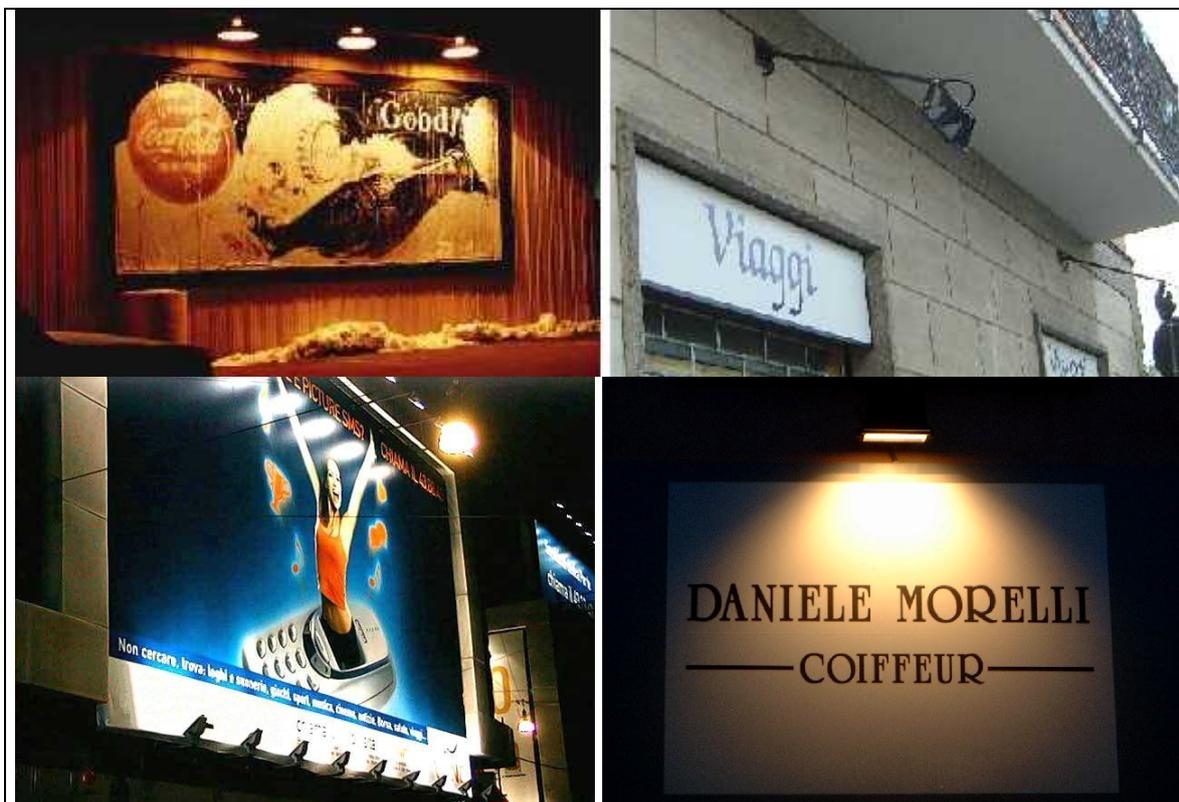
Fig. 16 – Alto-Sinistra: Insegna conforme alla L.r.17/09 con emissione di 0cd/klm a 90° ed oltre.
