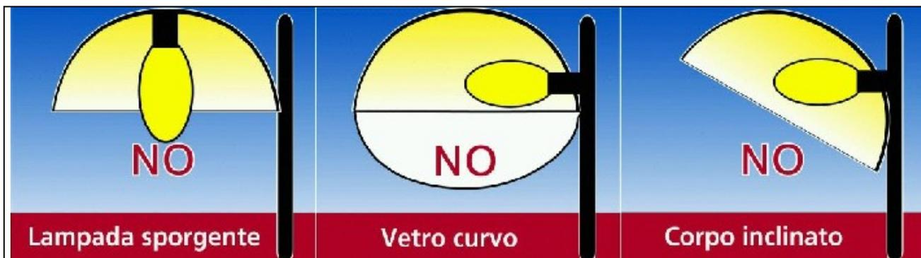
Figura 1 – Tipologie di apparecchi non ammessi dalla Lr17/09
